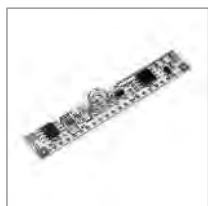
touch LED INSIDE dimmable switch włącznik dotykowy ściemniający LED INSIDE 12-24V/36W
